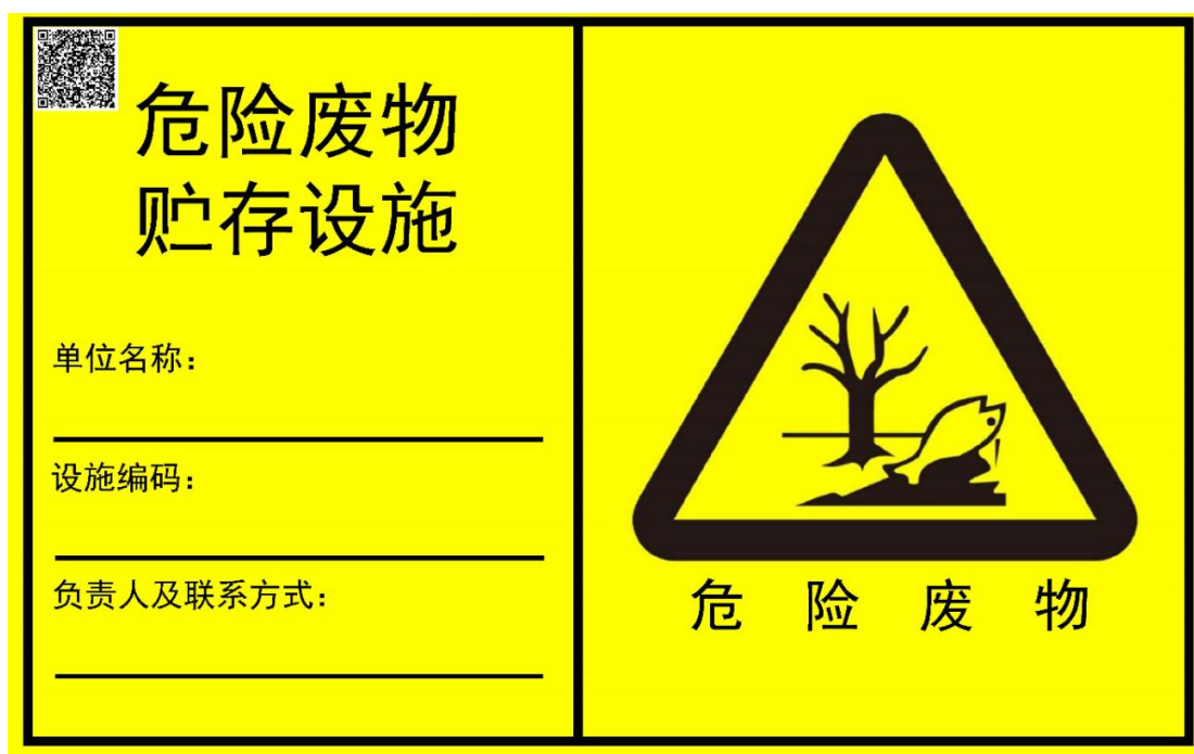
图 4-3 危险废物贮存设施标志（横版）
