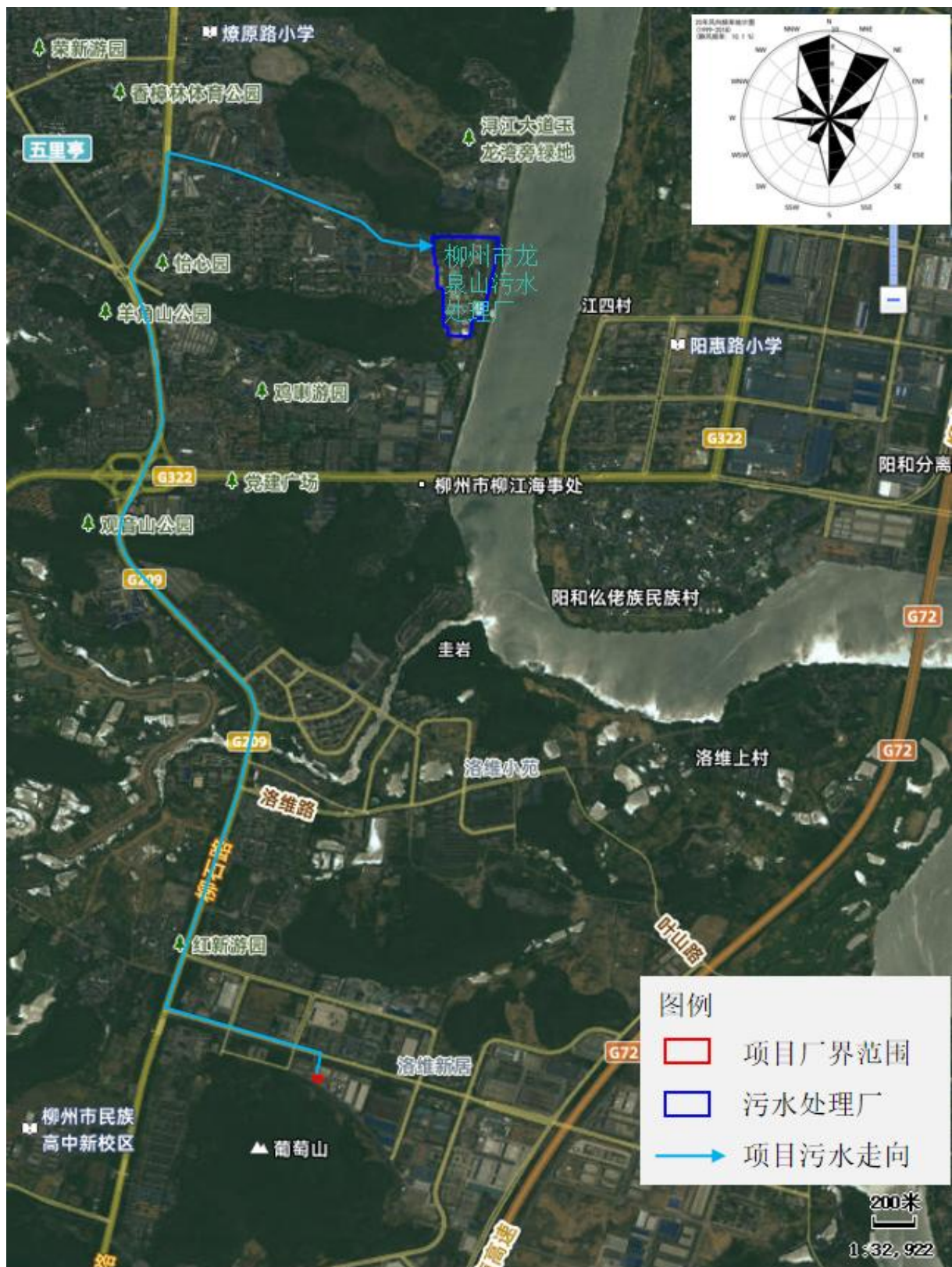
附图 8 项目污水走向图
