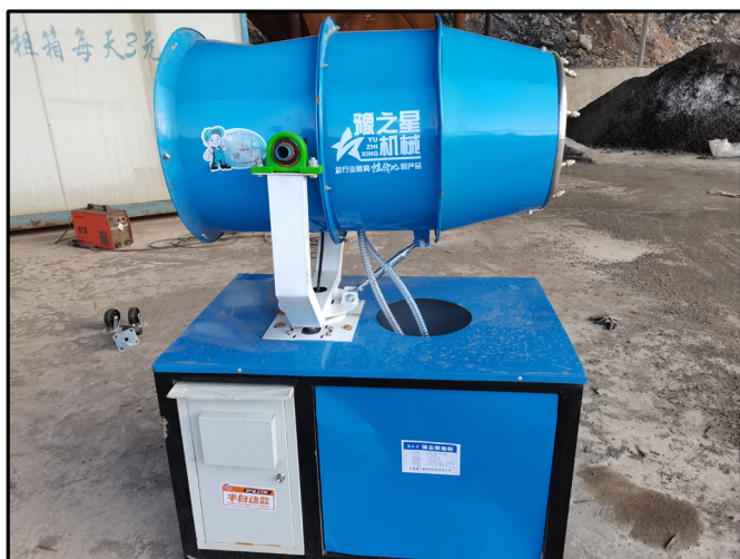
技改项目堆场雾炮机
